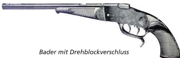
*Bader mit Drehblockverschluss*
