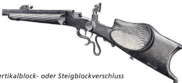
*Vertikalblock- oder Steigblockverschluss*
